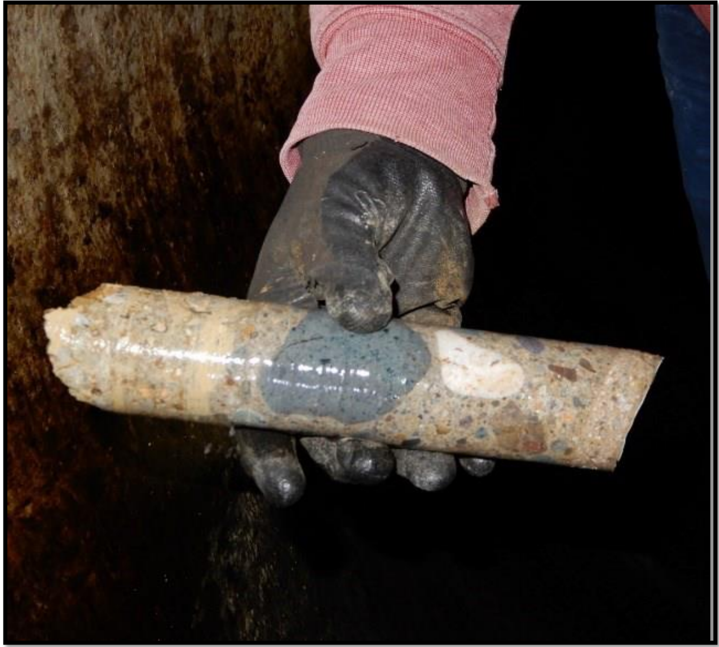
Extracción de muestras de hormigón para los estudios realizados con el aparato de ultrasonido.
